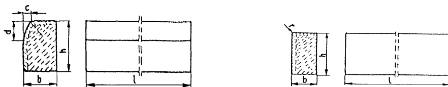
Tablica 1. Wymiary krawężników betonowych
